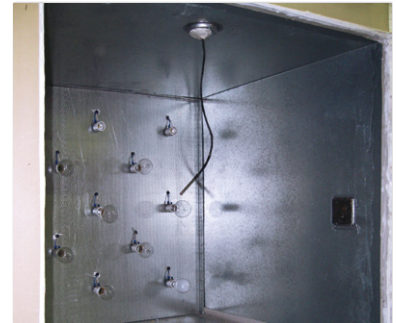
Thermal hot box interior
